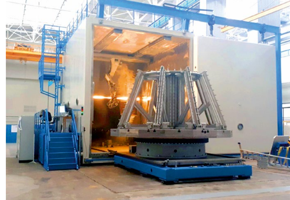
Установка электронно-лучевой сварки АЭЛТК-160 для сварки корпусных конструкций космического корабля «Орел».
