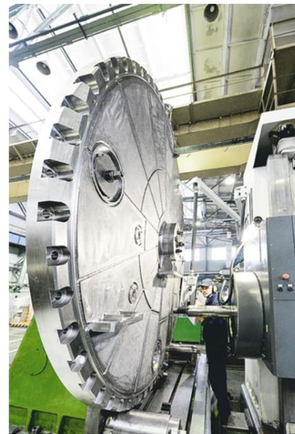
На станке – часть кожуха подвижного отражателя. По его габаритам можно судить о размерах в целом исследовательского реактора.
