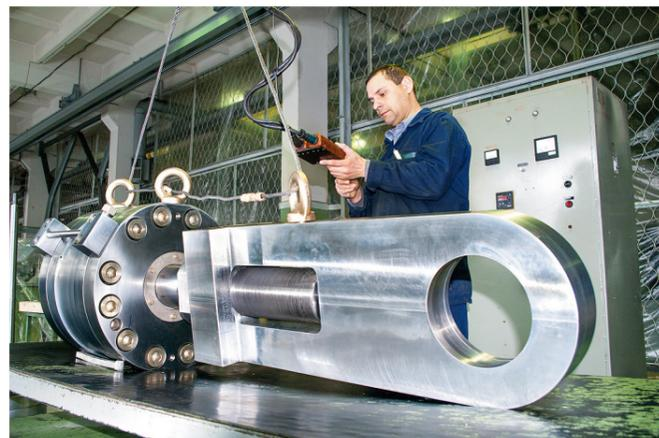
Гидроамортизаторы предназначены для защиты оборудования АЭС от разрушения во время землетрясений и других чрезвычайных происшествий.
