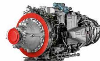
Двигатель ТВ7-117СТ-01 – турбовинтовой, мощность на форсаже до 3000 л.с. Является глубокой модернизацией ТВ7-117, разработка которого началась еще в 80-е годы прошлого века.
