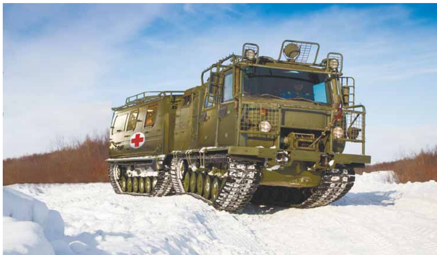
Медицинское отделение санитарного автомобиля на базе двухзвенного гусеничного транспортера-тягача ГАЗ 3344-20
