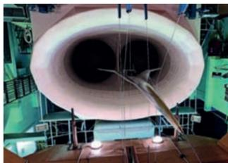
Модель суперзвукового самолета ЦАГИ на испытаниях в аэродинамической трубе.
