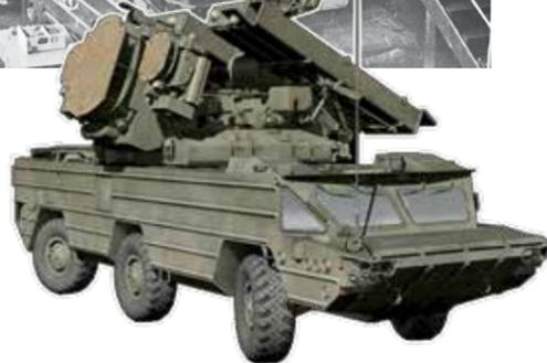
антенны за секунду) позволяет боевой машине оперативно реагировать на изменение воздушной обстановки, а малое время реакции от обнаружения цели до пуска по ней ракеты (5-10 сек.) – успешно отражать налет высокоскоростных (до 2 и более скоростей звука) средств воздушного нападения. «Торы» способны обнаружить малогабаритные (ЭПР – 0,1 м<sup>2</sup> и менее) цели и перехватить их, даже если они летят практически вплотную к земле (менее 10 метров).
